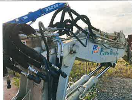
② バック 油圧配管・ホース
