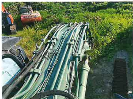
① : フロント 掘削装置・ボーム
