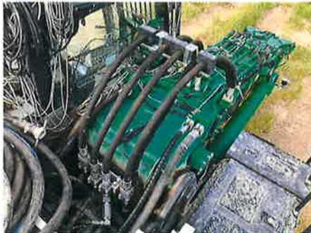
◎ : フロント 油圧配管・ホース
