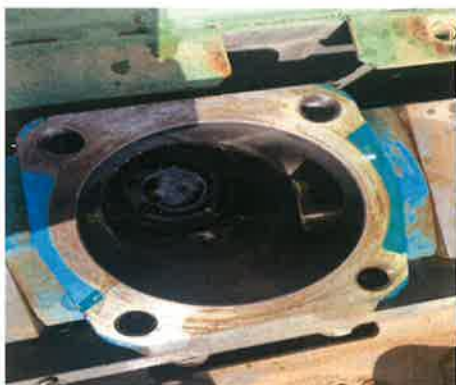
△: 上部旋回体 作動油タンク・作動油
