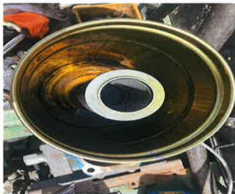
△: 上部旋回体 作動油タンク・作動油
