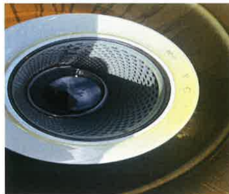
△: 上部旋回体 作動油タンク・作動油 切粉が見受けられます。
