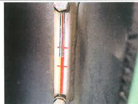
○ : 上部旋回体 作動油タンク・作動油
