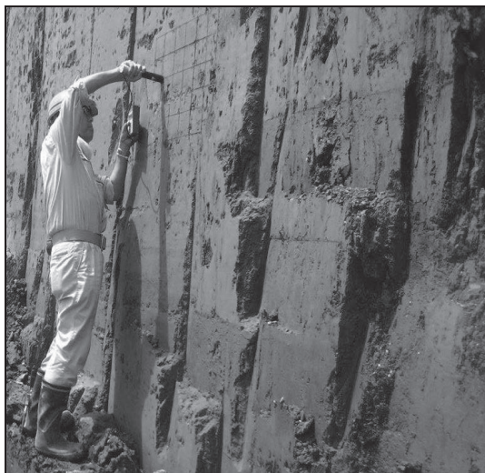
写真 3.4-5 パワーブレンダー工法硬度計使用状況
