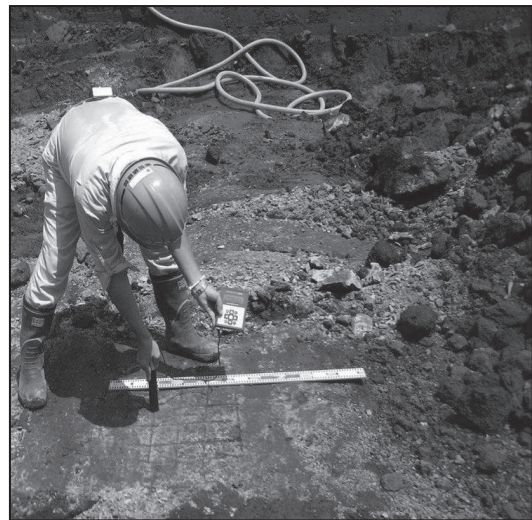
写真 3.4-5 パワーブレンダー工法硬度計使用状況
