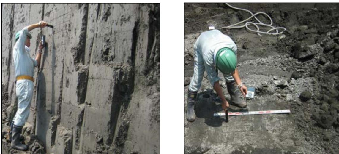
写真 3.4-6 パワーブレンダー工法硬度計使用状況
